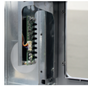
Fotozelle zur Erfassung von Bechern bis zu 3 verschiedenen Höhen
